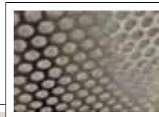
Grille en aluminium perforée de 8 mm
